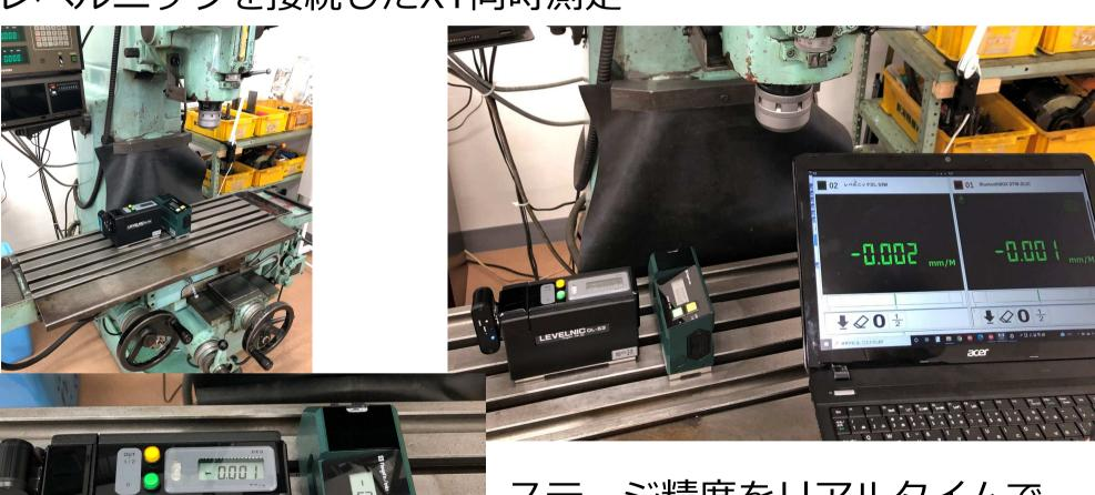
ステージ精度をリアルタイムで 取込み、測定が可能・検査記録に リアルタイムで記載できます。
